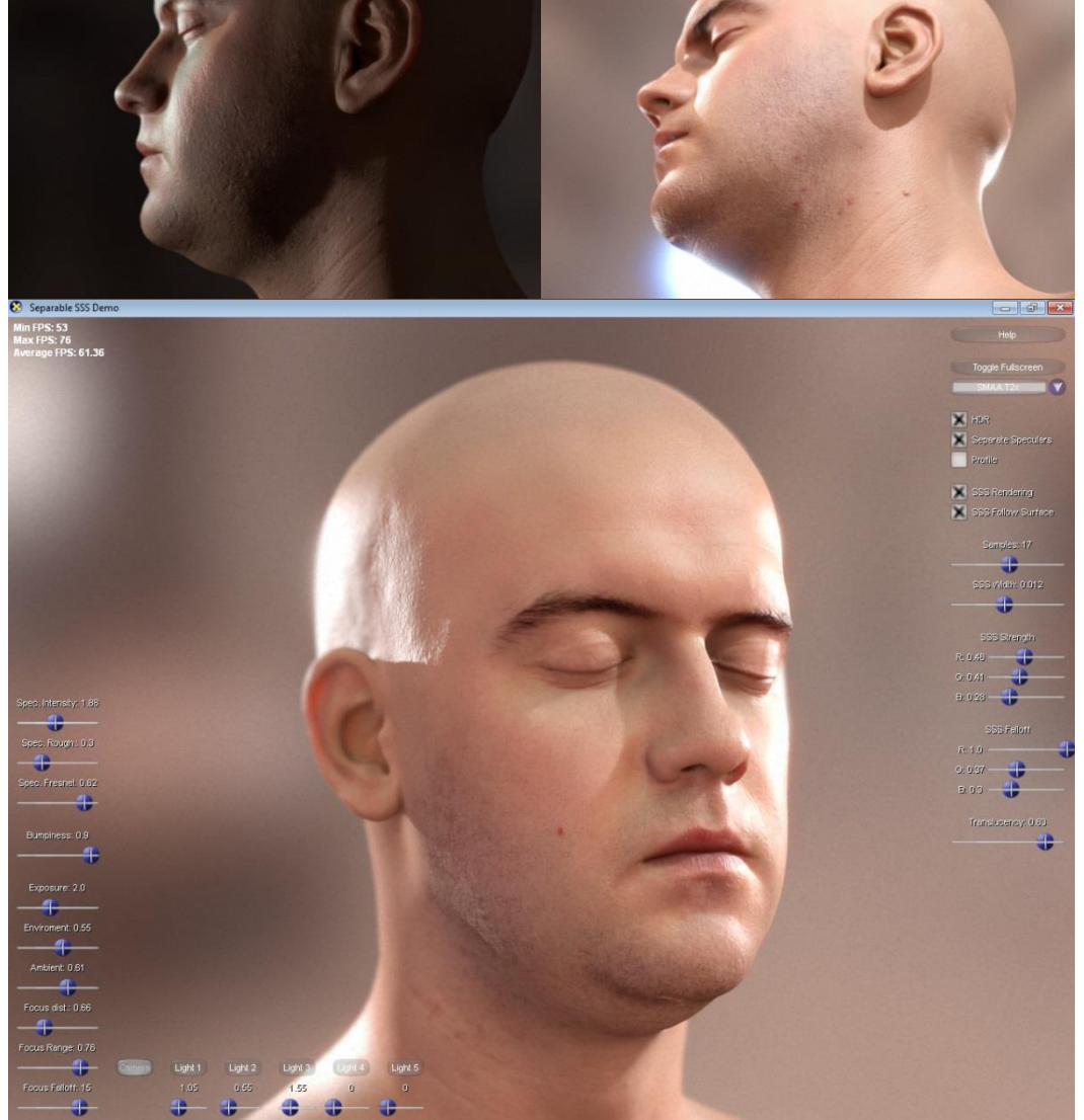
Şekil 2.4. Jimenez et al. (2012)'ın yeni ayrılabilir yüzey altı saçılımı tekniği son olarak kullanılan doku-uzayı algoritmaları (d'Eon et al., 2007) ile kıyaslanabilir sonuçlar ortaya koymaktadır, ve bu durum bu metodu oyunlar için uygun kılmaktadır. Altındaki görüntü ise yazarlar tarafından sağlanan gerçek zamanlı “editing” ara yüzünü göstermektedir (Jimenez et al., 2012).
